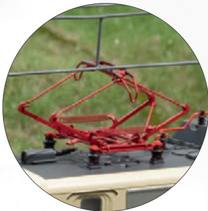
Pantographes nouvelle version type DBS 54 relevables et abaissables en mode numérique
