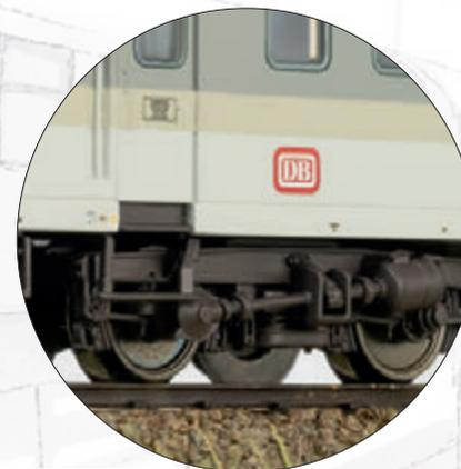
Le Dm 903 avec bogies type Minden-Deutz lourd et frein à double sabot, ici bogie 2 avec générateur d'essieu type D150 sur le côté droit du wagon
