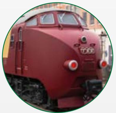
Le design de la tête motrice du RAM 501 est déterminé par le capot arrondi. Sur le modèle, le fanal à trois feux et les feux rouges de fin de convoi s'inversent en fonction du sens de marche. L'attelage Scharfenberg est lui aussi reproduit.
